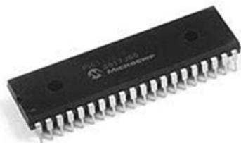
**Gambar 1.3. Bentuk kemasan PDIP dari PIC18F4550**
