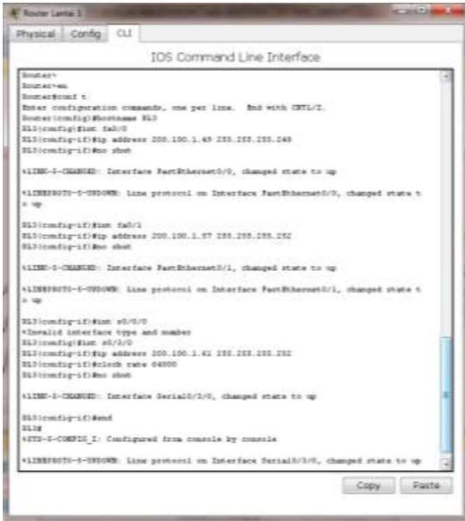
Proses Pengaktifan Interface pada Router Lantai 3
