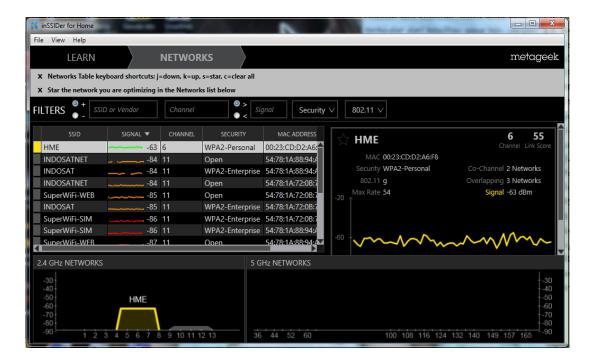
Gambar tersebut merupakan tampilan menyeluruh dari capturing Filters Access Point yang diperoleh, grafik signal yang berjalan pada suatu Access Point yang diuji beserta tataran range kerja pada settingan Access Point yang digunakan. Hal tersebut akan dikupas untuk keterangan lebih lanjut pada penjabaran di bawah ini.
